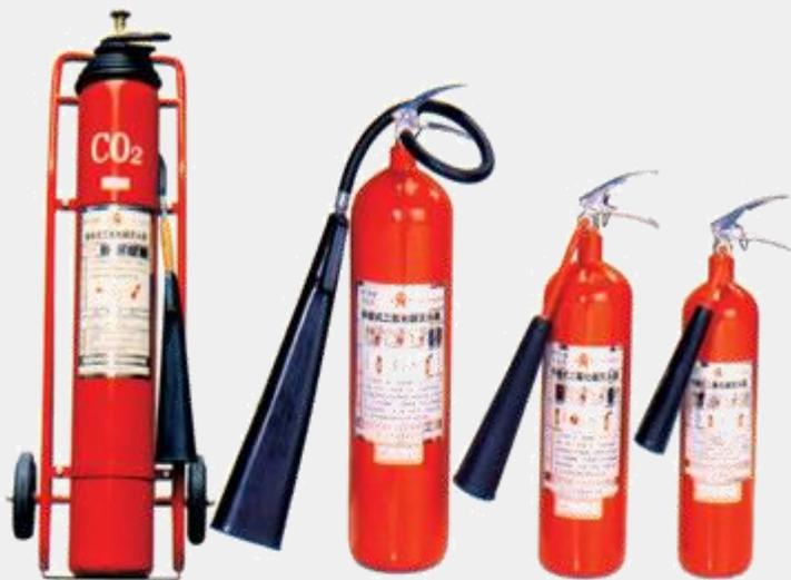
二氧化碳不导电，不污损仪器设备，适用于扑救电器、精密仪器、价值高的生产设备、图书馆、档案馆等火灾。二氧化碳灭火器不能扑灭金属钾、钠、镁、铝等物质的火灾，因为二氧化碳与以上物质能起化学作用。
