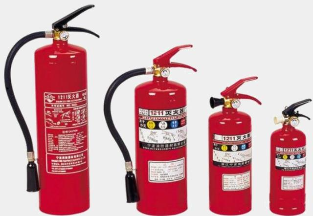
1211（二氟一氯一溴甲烷）。由于灭火效能高、毒性低，现在多用于飞机、轮船、坦克和内燃机车等方面。这种灭火剂一般是充填在灭火机内，以氮气充压，并可根据需要，将灭火剂充填在固定灭火装置内。（因对臭氧层有破坏，现在正逐步减少其使用）。
